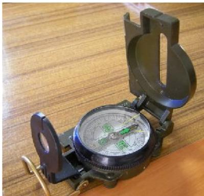
Mirip dengan kompas prisma, hanya saja optik yang digunakan berupa lensa cembung, yang berfungsi sama untuk melihat/memperbesar skala-skala sudut kompas.
