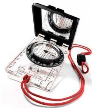
Pada kompas ini terdapat clinometers yang dipakai untuk mengukur sudut inklinasi, dimana jarum indicator inklinasi ( non magnet ) digabungkan dalam tempat kompas.
